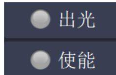
**引导红光：** 打开/关闭激光器红光，如果开关开启 **红光 (mA) 0** **打开** 此时会显示红光电流，同时对指示灯会亮起；
